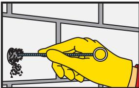
Не менее двух раз тщательно прочистить отверстие при помощи круглой металлической щётки. Диаметр щётки должен быть больше диаметра отверстия.
